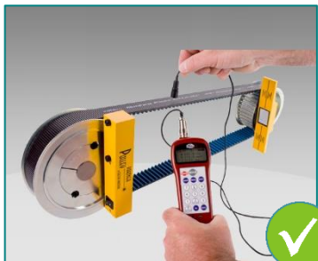
2 : Courroie correctement tendue
