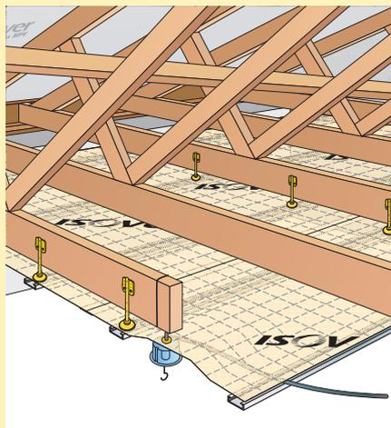
**2** - Passer le boîtier DCL et le câble électrique entre les fourrures et la membrane. La membrane est souple et peut être déformée localement.
