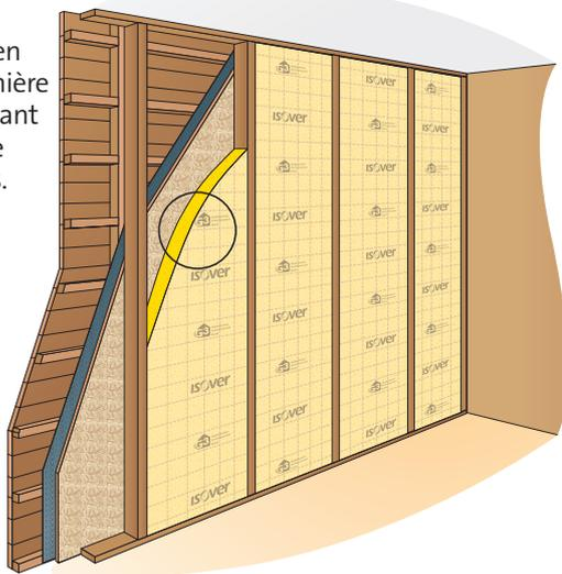
**2** - Agrafer la membrane d'étanchéité à l'air **Vario Xtra** sur les montants.
