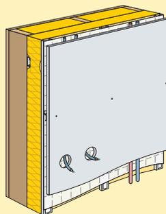
**3** - Comprimer localement la membrane et l'isolant pour intégrer les boîtiers.
