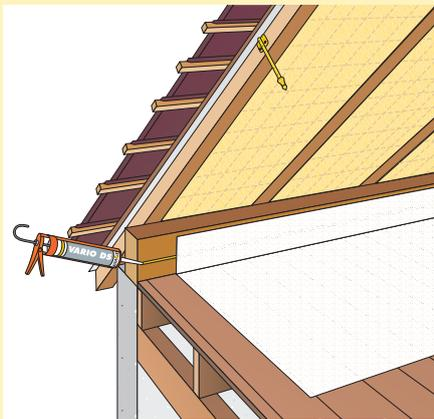
**1** - Fixer une bande de membrane **Vario Duplex** sur le mur ou la panne sablière à l'aide du mastic **Vario DS** et la laisser en attente.
