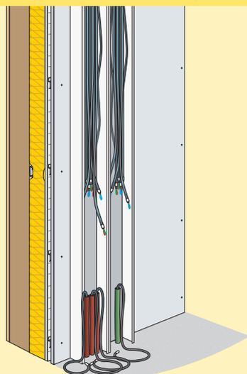
**1** - Fixer la GTL sur la plaque de plâtre, côté étanche à l'air. Toutes les gaines électriques passeront ainsi côté étanche à l'air.
