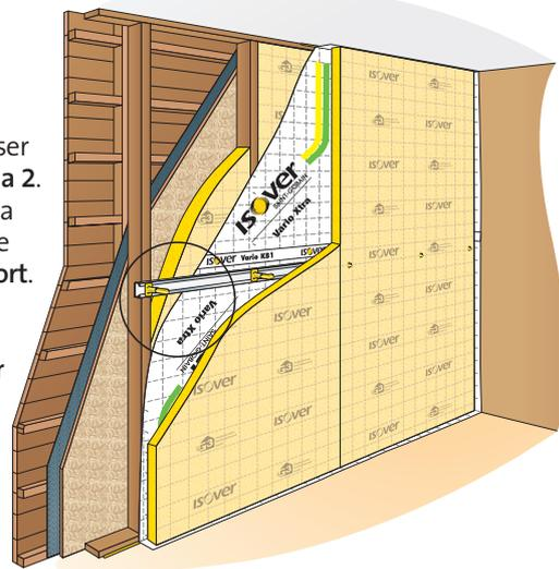
**5** - Placer la rangée de fourrures devant l'isolant. Passer les gaines dans l'espace technique disponible entre les fourrures et l'isolant.
