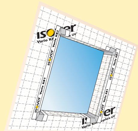
**6** - Fermer les angles avec le mastic puis achever l'étanchéité à l'air avec les adhésifs **Vario KB1** et **Vario Multitape 150**. Mettre en place l'ossature métallique et le parement.
