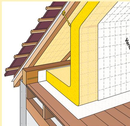
**2** - Mettre en place l'isolant **Isoconfort** et la membrane **Vario Duplex** (prévoir un recouvrement de 10 cm avec la membrane laissée en attente).
