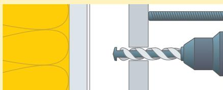
**1** - Percer le parement en faisant attention de ne pas percer la membrane. Utiliser une butée sur le perforateur.
