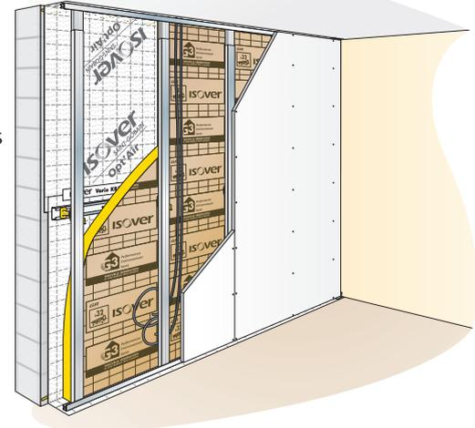
**4** - Raccorder la membrane **Opt'air** à la membrane d'étanchéité à l'air **Vario Duplex** ou **Stopvap** en jointoyant les deux lés de membranes avec l'adhésif **Vario KB1**.
