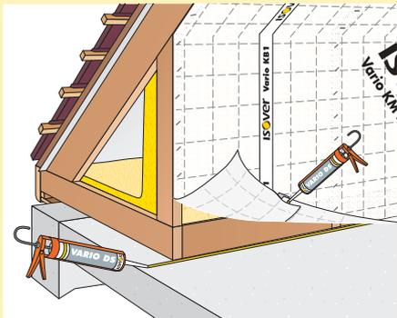
**1** - En périphérie, laisser la membrane **Vario Duplex** déborder de 10 cm. Coller la membrane sur le sol à l'aide du mastic **Vario DS**. Bien remplir l'intérieur du recouvrement de membrane avec du mastic **Vario DS**.
