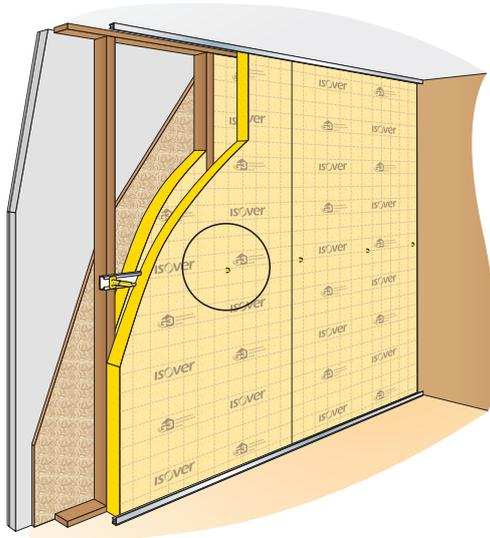
**3** - Mettre en place la rangée de fourrures devant l'isolant. Fixer la membrane d'étanchéité à l'air **Stopvap 90** sur les montants à l'aide d'un adhésif double-face.
