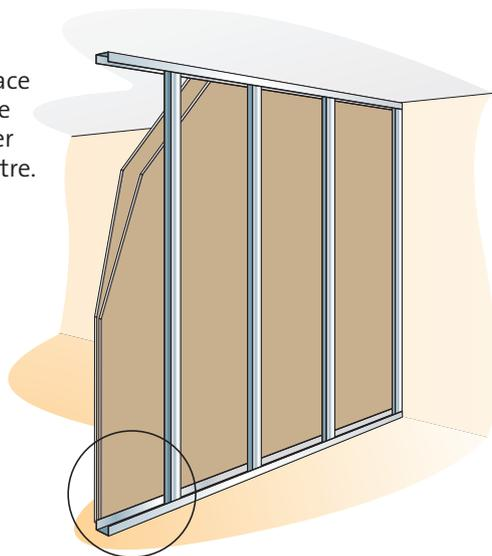
**2** - Placer l'isolant PAR entre les montants.
