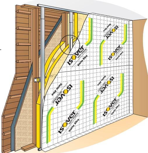
**4** - Jointoyer les lés de membrane avec de l'adhésif **Vario KB1**. Assurer l'étanchéité à l'air en périphérie à l'aide du mastic **Vario DS**.
