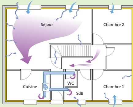
Mauvaise étanchéité à l'air : renouvellement d'air imparfait
