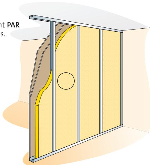
**3** - Fixer la membrane d'étanchéité à l'air sur les montants à l'aide d'un adhésif double-face.
