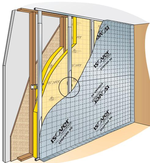
**4** - Jointoyer les lés de membrane avec de l'adhésif **Vario KB1**. Assurer l'étanchéité à l'air en périphérie à l'aide du mastic **Vario DS**.
