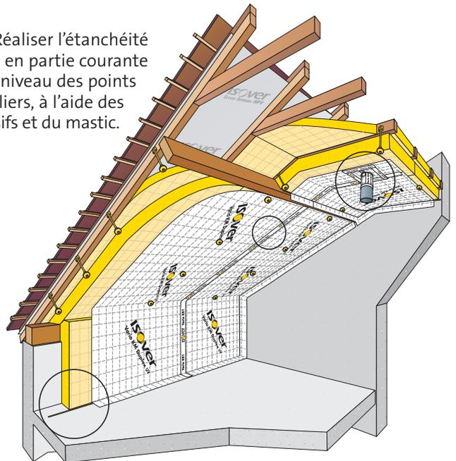
**6** - Clipser les fourrures sur la clé de la suspente et passer les gaines électriques entre les fourrures et la membrane. Visser les plaques de plâtre dans l'ossature.
