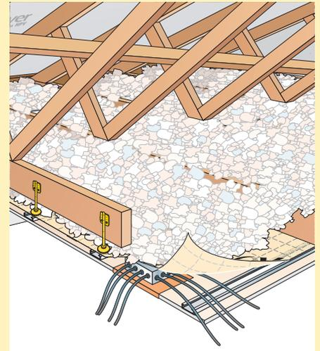
**3** - Visser les plaques de plâtre dans l'ossature. Prévoir une trappe de visite pour accéder au réseau électrique par le dessous.
