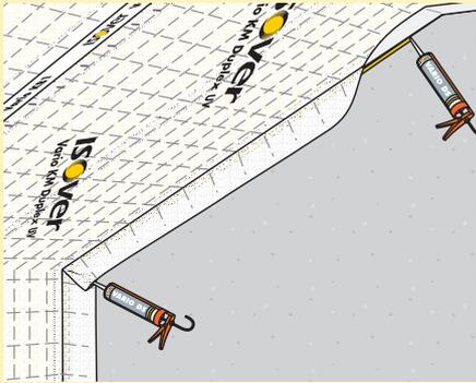
**1** - En périphérie, laisser la membrane **Vario Duplex** déborder de 10 cm. Coller la membrane sur le pignon à l'aide du mastic **Vario DS**. Dans les coins, remplir le pli de l'angle de membrane avec du mastic **Vario DS**.
