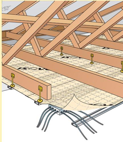
**2** - Passer le boîtier et les gaines électriques entre les fourrures et la membrane. La membrane est souple et peut être déformée localement.
