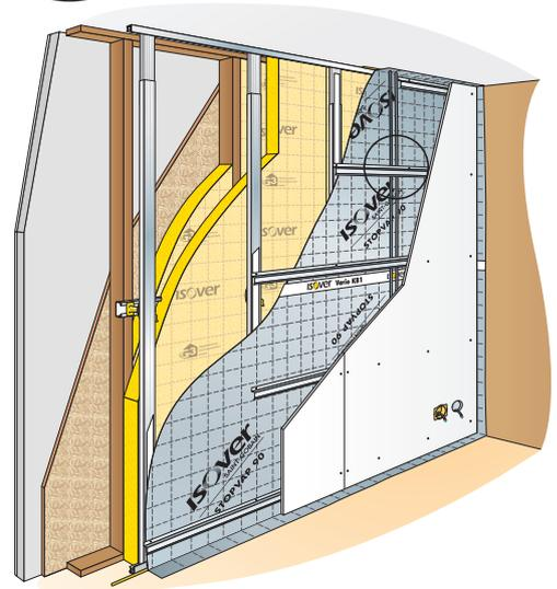
**5 bis** - Utiliser des tasseaux bois pour créer l'espace technique et passer les gaines. Fixer les plaques de plâtre sur les tasseaux.
