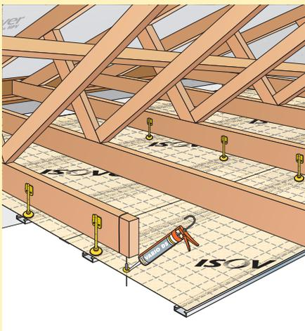
**1** - Le système d'étanchéité à l'air et l'ossature métallique sont mis en place. Le câble de fixation du boîtier DCL est fixé à l'entrait et laissé en attente en traversant la membrane. Réaliser l'étanchéité à l'air au pourtour du câble à l'aide du mastic **Vario DS** ou de l'adhésif **Vario Multitape**.
