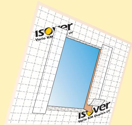
**3** - Préparer deux bandes de membrane de largeur de l'épaisseur de l'isolation + 15 cm et de longueur égale à la hauteur de la fenêtre + 20 cm pour assurer le recouvrement des angles.
