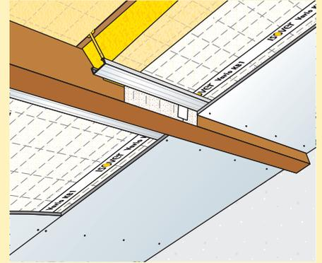
**3** - Couper les morceaux de membrane qui dépassent de la plaque de plâtre et faire les joints.
