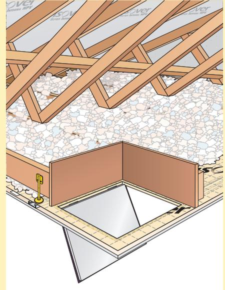
**3** - Dans le cas d'une isolation avec de la laine à souffler, protéger l'entourage de la trappe étanche à l'air.
