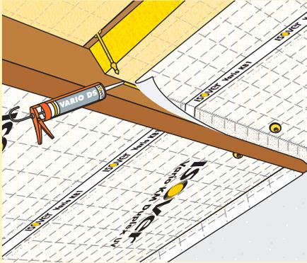
**1** - En périphérie, laisser la membrane **Vario Duplex** déborder de 10 cm. Coller la membrane sur l'élément de charpente à l'aide du mastic **Vario DS**.
