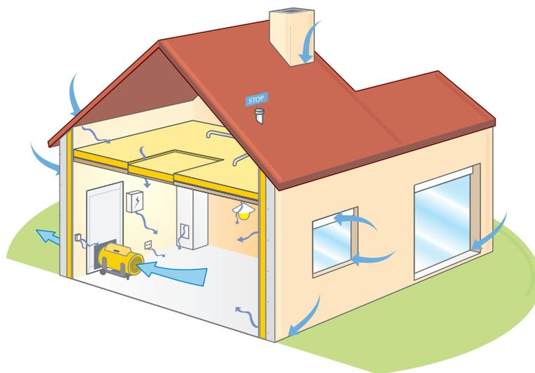
Elle évalue la performance d'étanchéité à l'air d'un bâtiment en terme de  $Q_{4Pasurf}$  ( $0,6$  ou  $1 \text{ m}^3/(\text{h} \cdot \text{m}^2)$ ) rapporté à sa surface de parois froides.
