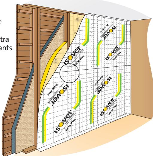
**3** - Jointoyer les lés de membrane avec de l'adhésif **Vario KB1**. Assurer l'étanchéité à l'air en périphérie à l'aide du mastic **Vario DS**.
