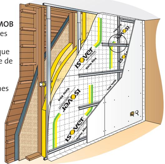
**5 bis** - Utiliser des tasseaux bois pour créer l'espace technique et passer les gaines. Fixer les plaques de plâtre sur les tasseaux.
