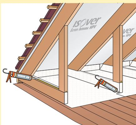
**1** - Fixer une bande de membrane **Vario Duplex** sur les fermettes à l'aide du mastic **Vario DS** et la laisser en attente.
