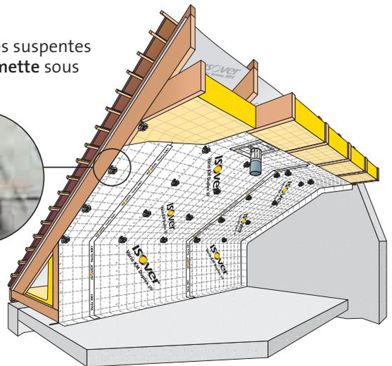
**6** - Clipser les fourrures Optima 240 sur la rosace de la suspente et passer les gaines électriques entre les fourrures et la membrane. Visser les plaques de plâtre dans l'ossature.
