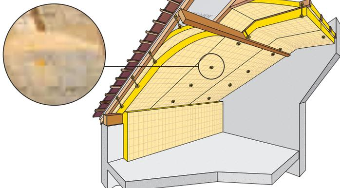
**4** - Tendre la membrane **Vario Duplex** entre les suspentes et l'embrocher sous la rondelle de la suspente **Intégra 2**. Clipser la clé sur la rondelle. Le "clic" sonore garantit l'étanchéité à l'air.
