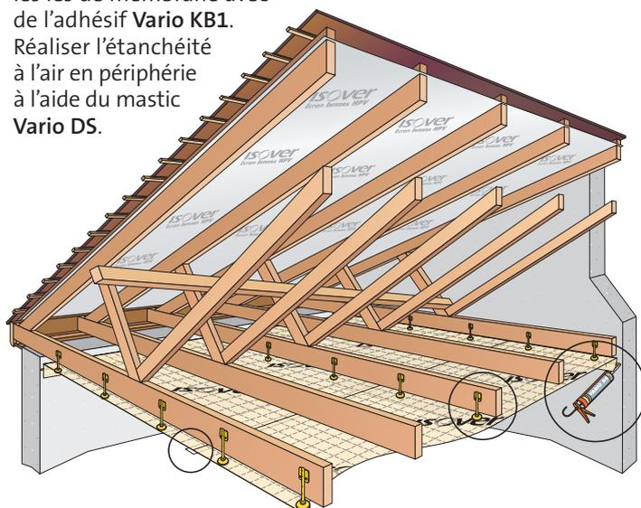
**3** - Clipser les fourrures sur la clé de la suspente et passer les gaines électriques entre les fourrures et la membrane.
