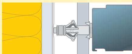
**2** - Utiliser des chevilles à expansion à bout plat de longueur adaptée pour éviter de percer la membrane.
