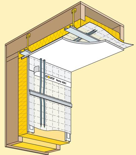
**3** - Jointoyer la membrane en attente avec la membrane d'étanchéité à l'air du mur.
