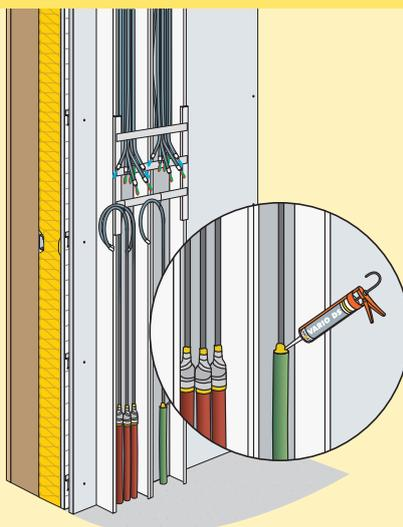
**2** - Assurer l'étanchéité à l'air au pourtour et dans les gaines venant de l'extérieur (arrivée d'électricité, téléphone, interphone, portail, ...) à l'aide de l'adhésif Vario Multitape et du mastic Vario DS.
