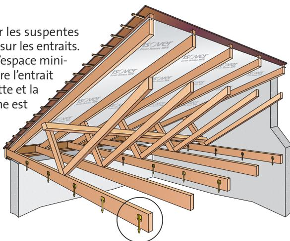
**2** - Embrocher la membrane **Stopvap** sur la rondelle de la suspente **Intégra 2**. Clipser la clé sur la rondelle. Jointoyer les lés de membrane avec de l'adhésif **Vario KB1**. Réaliser l'étanchéité à l'air en périphérie à l'aide du mastic **Vario DS**.
