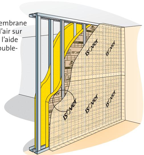
**5** - Jointoyer les lés de membrane avec de l'adhésif Vario KB1. Assurer l'étanchéité à l'air en périphérie à l'aide du mastic Vario DS.
