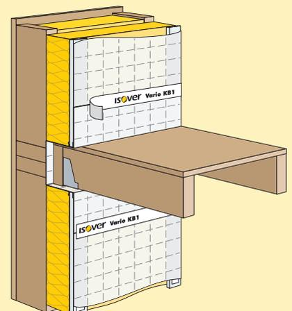
**3** - Raccorder la membrane en attente avec la membrane d'étanchéité à l'air des murs à l'aide de l'adhésif **Vario KB1**.
