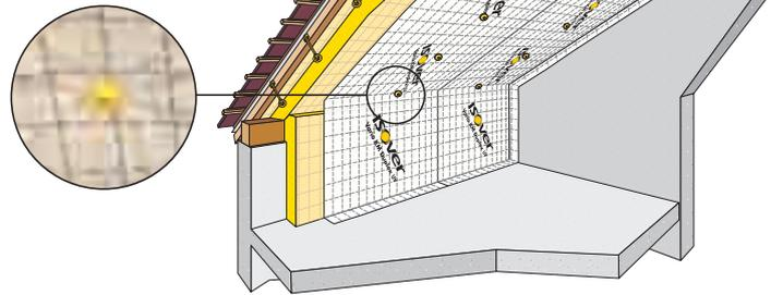
**5** - Réaliser l'étanchéité à l'air, en partie courante et au niveau des points singuliers, à l'aide des adhésifs et du mastic.
