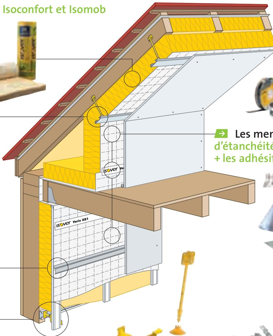
→ Les membranes d'étanchéité à l'air Isover + les adhésifs et le mastic
