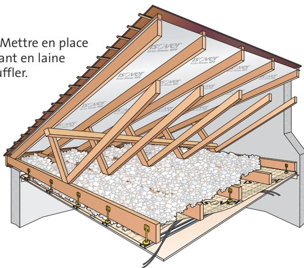
**5 bis** - Dans le cas d'un isolant en laine de verre, il sera mis en place entre les entrails de fermette, avant la pose de la membrane.
