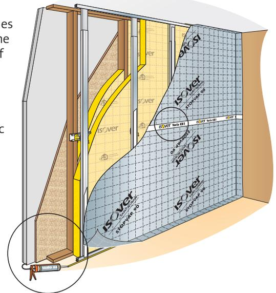
**5** - Fixer les Profilés **Stil® MOB** sur les fourrures pour créer un espace technique entre la plaque de plâtre et la membrane. Passer les gaines dans l'espace technique. Visser les plaques de plâtre sur les Profilés **Stil® MOB**.
