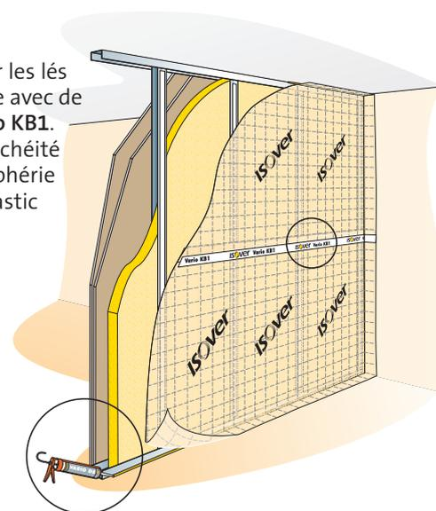
**5** - Mettre en place la deuxième rangée d'ossature. La membrane sera protégée par les 2 épaisseurs d'isolant.
