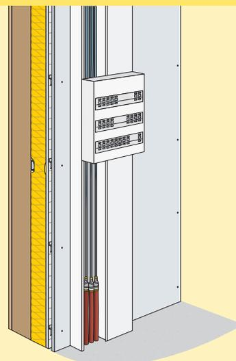
**3** - Faire les branchements dans le tableau électrique. L'étanchéité à l'air du réseau électrique est ainsi réalisée durablement.
