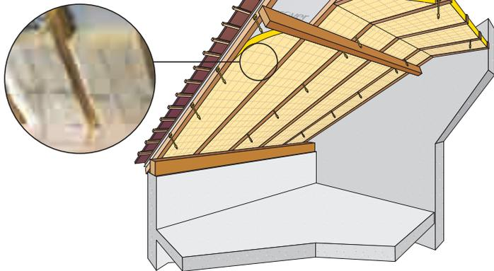
**3** - Embrocher la deuxième couche d'**Isoconfort 35** sur les suspentes et clipser la rondelle de la suspente.
