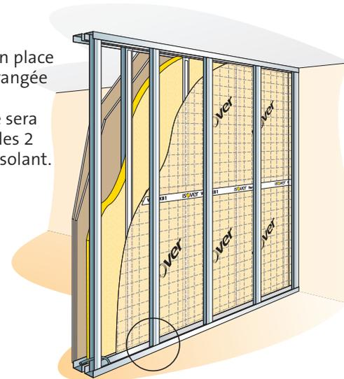
**6** - Placer la deuxième couche d'isolant et visser les plaques de plâtre.
