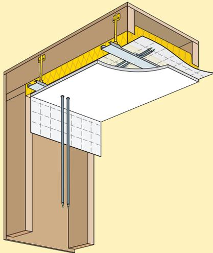
**1** - Laisser la membrane d'étanchéité à l'air en attente. Arrêter la plaque de plâtre du plafond juste après la dernière fourrure. Passer les gaines dans l'espace technique disponible entre la plaque de plâtre et la membrane.
