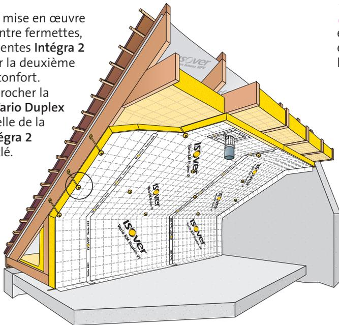
**2** - Clipser les fourrures sur la clé de la suspente et passer les gaines électriques entre la membrane et les fourrures. Visser les plaques de plâtre dans l'ossature.
