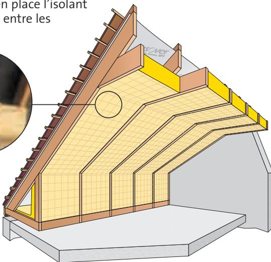
**3** - Agrafer la membrane Vario Duplex sur les fermettes.
