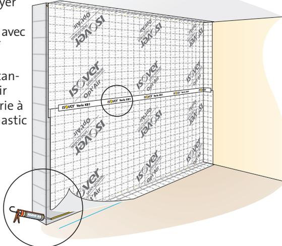
**3** - Fixer la fourrure horizontale et les lisses **Clip'Optima**. Clipser les appuis **Optima 2** et embrocher l'isolant. Mettre en place la rangée de fourrures devant l'isolant. Fixer les plaques de plâtre sur l'ossature.
