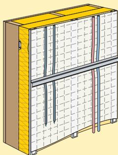
**2** - Visser le parement pré-percé, pour le passage des câbles, sur les Profilés Stil® MOB.
