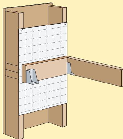
**2** - Fixer l'ossature du plancher bois en prenant la membrane en sandwich avec la structure verticale.
