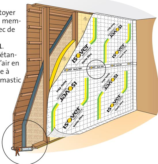
**4** - Fixer les fourrures horizontales sur les montants et clipser les appuis **Optima 2**. Mettre en place la deuxième couche d'isolant **Isoconfort**. Sa résistance thermique ne doit pas excéder la moitié de celle de la couche d'isolant entre montants.
