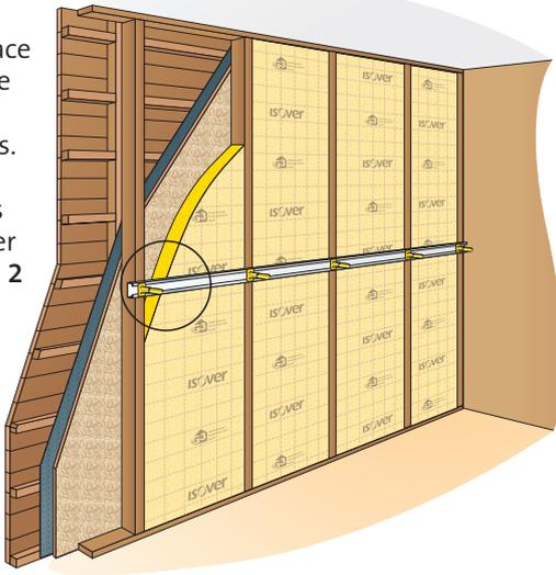
**2** - Mettre en place la deuxième couche d'isolant **Isoconfort**.
