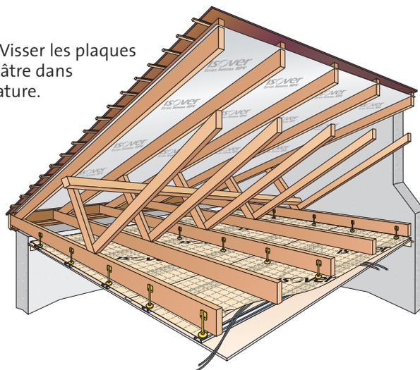
**5** - Mettre en place l'isolant en laine à souffler.
