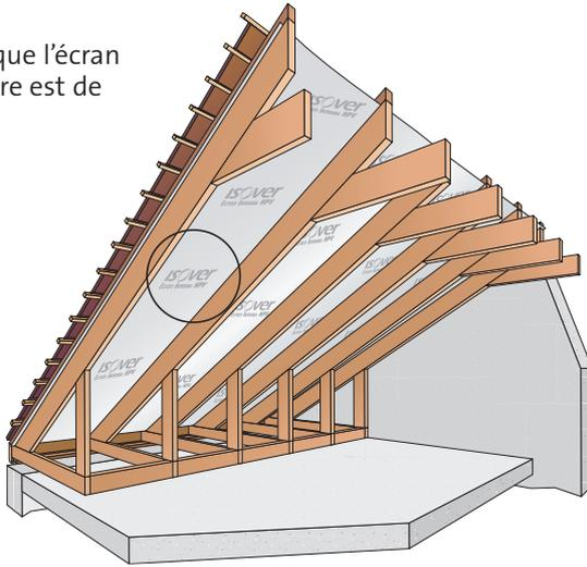
**2** - Mettre en place l'isolant Isoconfort 35 entre les fermettes.
