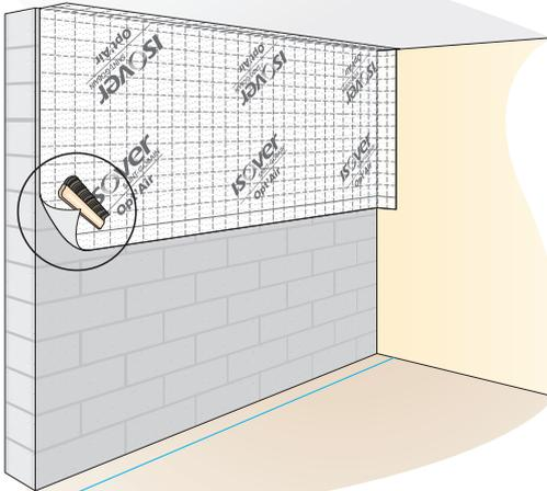
**2** - Jointoyer les lés de membrane avec de l'adhésif **Vario KB1**. Assurer l'étanchéité à l'air en périphérie à l'aide du mastic **Vario DS**.
