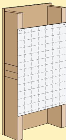
**1** - Agrafer sur l'ossature une bande de membrane suffisamment large de façon à pouvoir la raccorder à ses deux extrémités.
