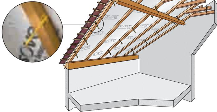
**2** - Découper les lés d'**Isoconfort** (épaisseur = hauteur du chevron, largeur = entraxe des chevrons + 1 cm). Coincer les panneaux entre les chevrons au fur et à mesure de leur découpe.
